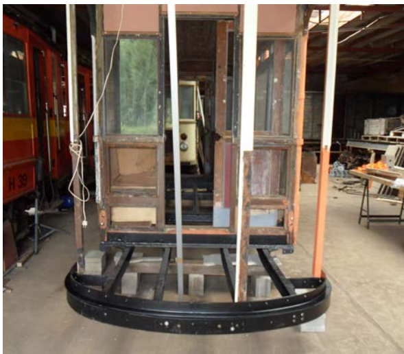
Met de opbouw is begonnen en de bak staat inmiddels op een nieuw basis-frame. Foto's Jos Koopmans en Raymond Naber.
