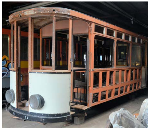
Met de opbouw is begonnen en de bak staat inmiddels op een nieuw basis-frame. Foto's Jos Koopmans en Raymond Naber.
