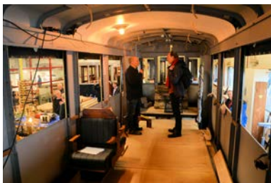
Twee plafondplaten zijn aangebracht. Als proef eveneens een verlichtings ornament. Buiten zijn de tandwielkasten aanwezig.
